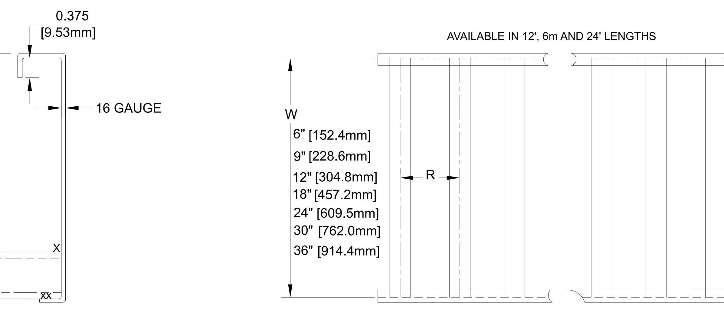
mm] RUNG SPACING mm] RUNG SPACING **RUNG CROSS-SECTION** mm] RUNG SPACING 0.75 mm] RUNG SPACING [19.1mm] XXXXX 18 GAUGE RUNG 1.0 [25.4mm] X=WELD
